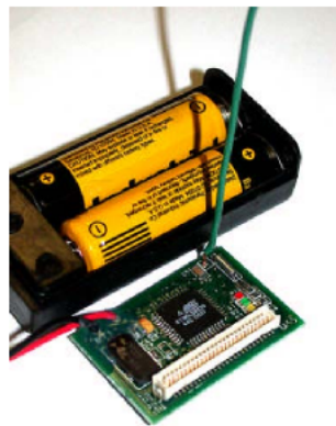
Abb. 3.6: Transmitter-Knoten mit Stromversorgung (916 Mhz Einkanal) Quelle: [DG02]
